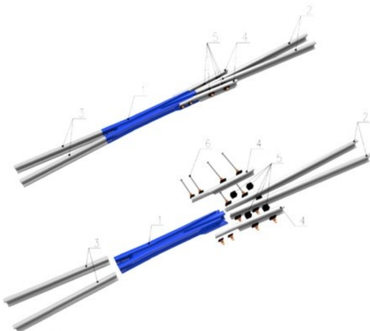
Obrázek 2 - Schéma srdcovky – provedení dodávané od roku 2019
