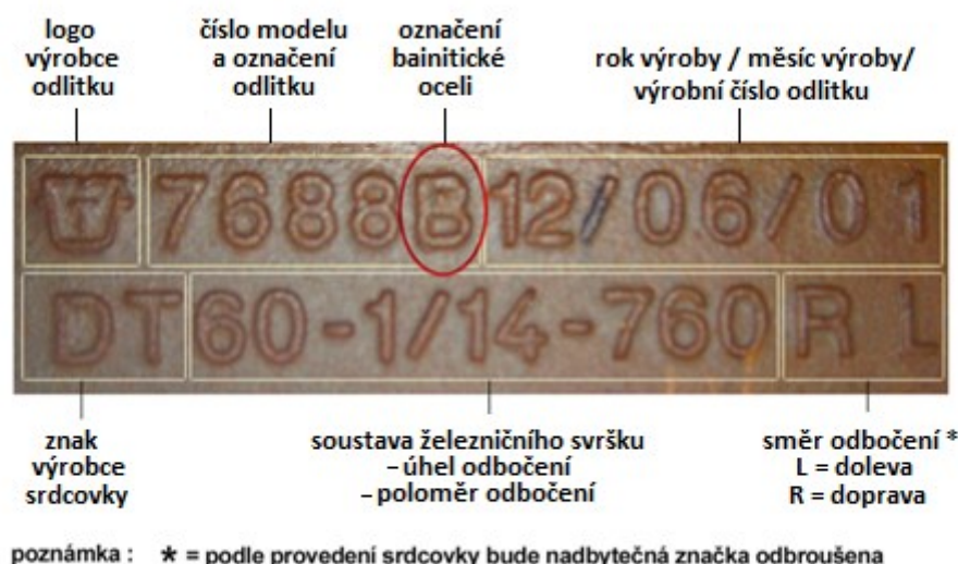
Obrázek 9 - Příklad označení odlitku srdcovky
