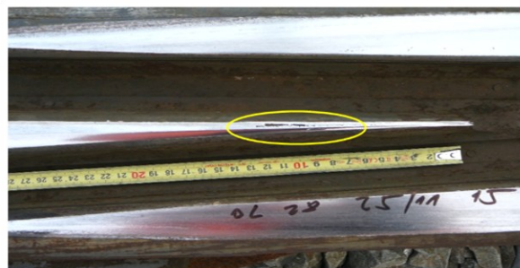
Povrchová vada na hrotu srdcovky
